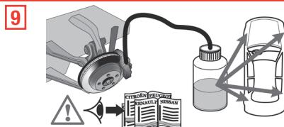
**10** Quand le liquide usagé est complètement remplacé et qu'il n'y a plus de bulle, la purge est terminée. Fermer la vis de purge.
