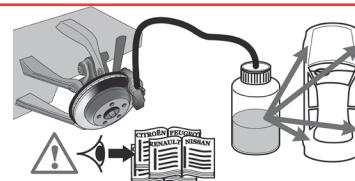
10 Quando o líquido usado é completamente substituído e não existirem mais bolhas, a purga está concluída. Fechar o parafuso de purga.
