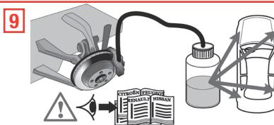
**10** Quando il liquido usato è stato sostituito completamente lo spurgo è terminato. Chiudere la vite di spurgo.
