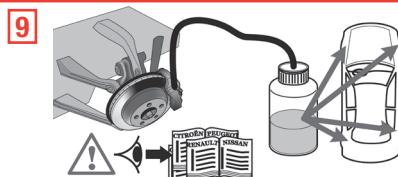
**10** Όταν το χρησιμοποιημένο υγρό αντικατασταθεί πλήρως και δεν υπάρχει καμία φυσαλίδα, η εξαέρωση έχει ολοκληρωθεί.
