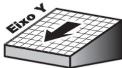
O desnivelamento seleccionado pode variar dentro de um intervalo de 10% (positivo ou negativo); tal intervalo é definido em relação ao eixo Y do instrumento, indicado pela gravação em relevo da mala de transporte.
