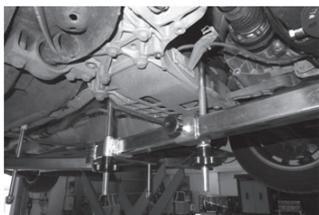
Posicionar os dois ganchos centrais de um lado e do outro do compartimento do motor. Em determinados casos só será possível posicionar um único gancho.
