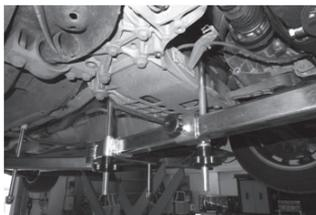
De twee centrale haken aan beide zijden van het subframe van de motor plaatsen. In sommige gevallen kan slechts een haak geplaatst worden.
