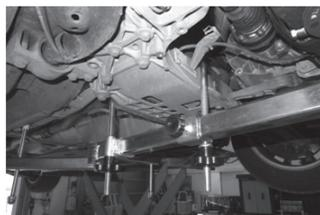
Positionner les deux crochets centraux de part et d'autre du berceau moteur. Dans certain cas il ne sera possible que de positionner un seul crochet.
