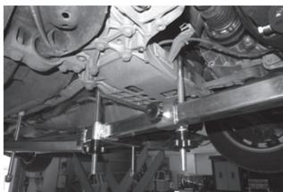
Posicionar los dos ganchos centrales a ambos lados del soporte motor. En ciertos casos sólo será posible posicionar un solo gancho.
