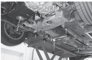
Het hele systeem onder druk zetten met de afstelschroeven. Controleren of het geheel stabiel staat. **De motorsteun DM.UES niet gebruiken als dat niet het geval is.**
