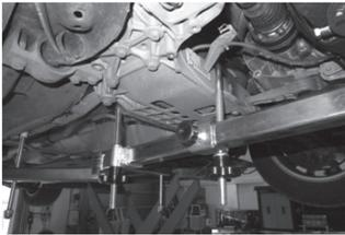
Die beiden mittleren Haken auf beiden Seiten des Motorträgers einhaken. In einigen Fällen kann nur ein Haken angebracht werden.
