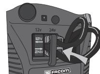
Controleer of het laadniveau hoger is dan 12,6V in de stand 12V of 25,2V in de stand 24V.
