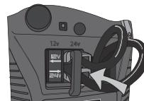
Certificar-se de que o nível de carga é superior a 12,6V na posição 12V ou 25,2V na posição 24V.
