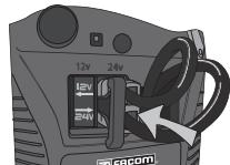
Compruebe que el nivel de carga es superior a 12,6V cuando esté en posición 12V o a 25,2V en la posición 24V.
