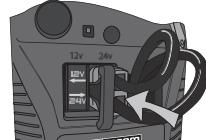
Vérifier que le niveau de charge est supérieur à 12,6V en position 12V ou 25,2V en position 24V.
