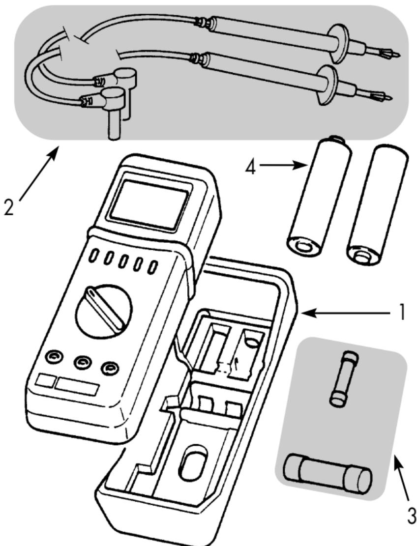
Per sostituire le pile o i fusibili, togliere le 3 viti sul semicofano posteriore dell'apparecchio.
