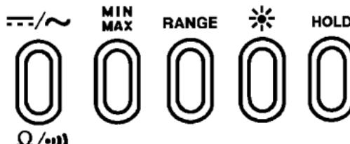
**.../~** Umschalten von Wechsel-  $\sim$  auf Gleichstrom  $\dots$ , oder umgekehrt, bei Spannungs- und Intensitätsmessungen.
