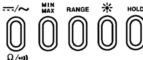
**... / ~** Per passare dall' alternata ~ alla continua ... o viceversa durante le misure della corrente e dell'intensità.
