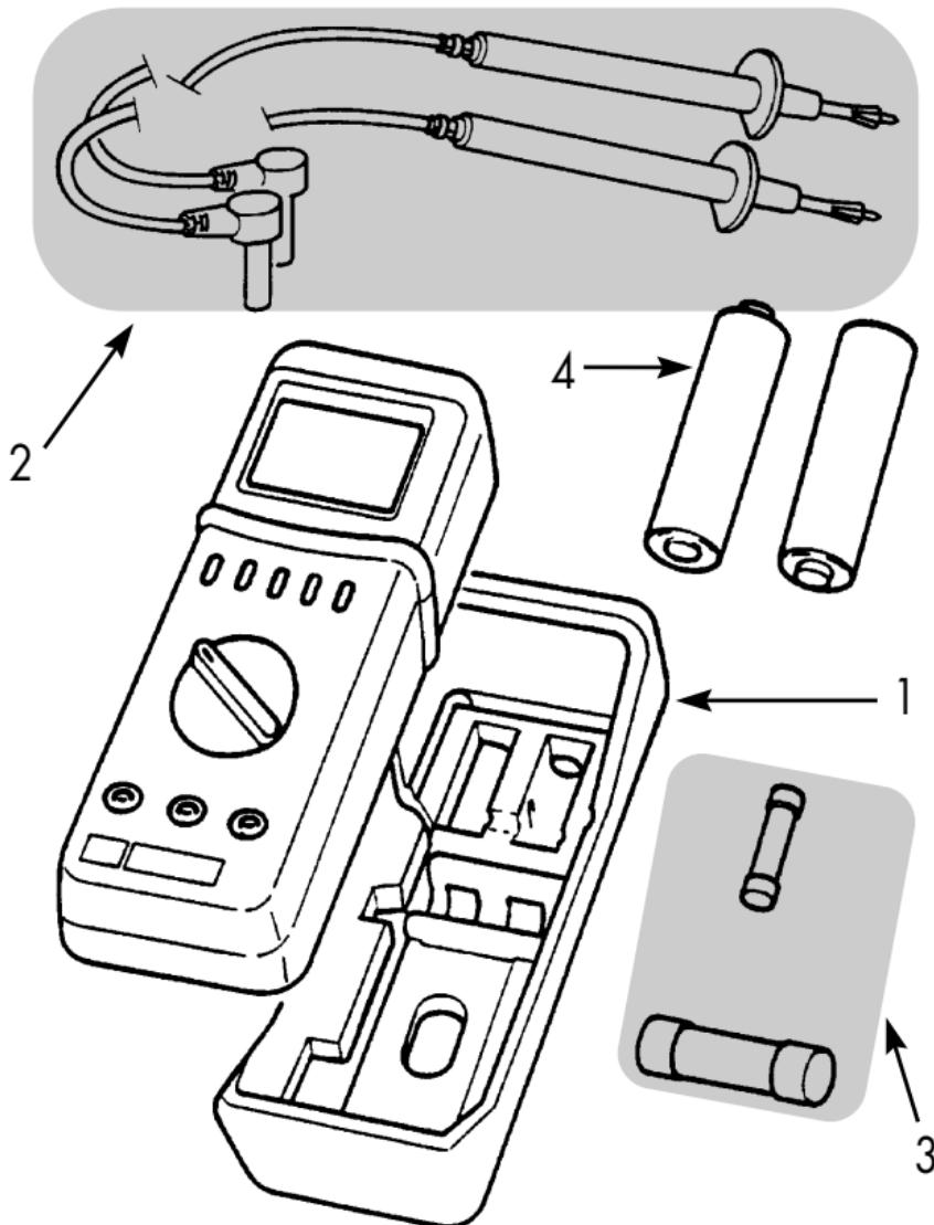
Para cambiar las pilas o los fusibles, es necesario retirar los 3 tornillos de la media caja trasera del aparato.
