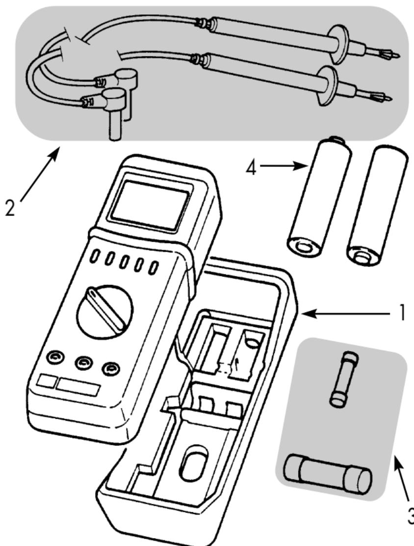
Pour changer les piles ou les fusibles, il faut déposer les 3 vis du demi boutier arrière de l'appareil.
