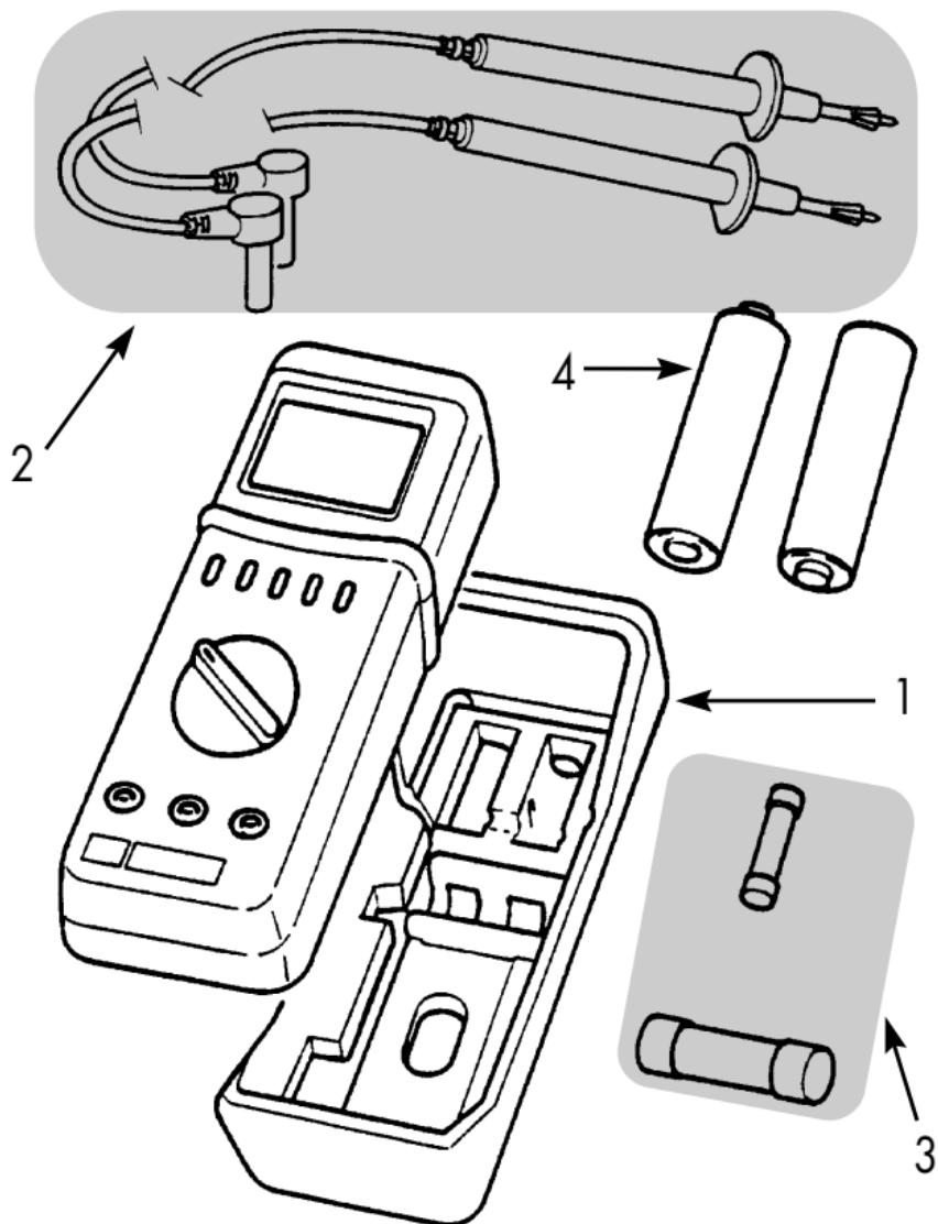
Um die Batterien oder die Sicherungen auszuwechseln, müssen die 3 hinteren Gehäuseschrauben abgeschraubt werden.
