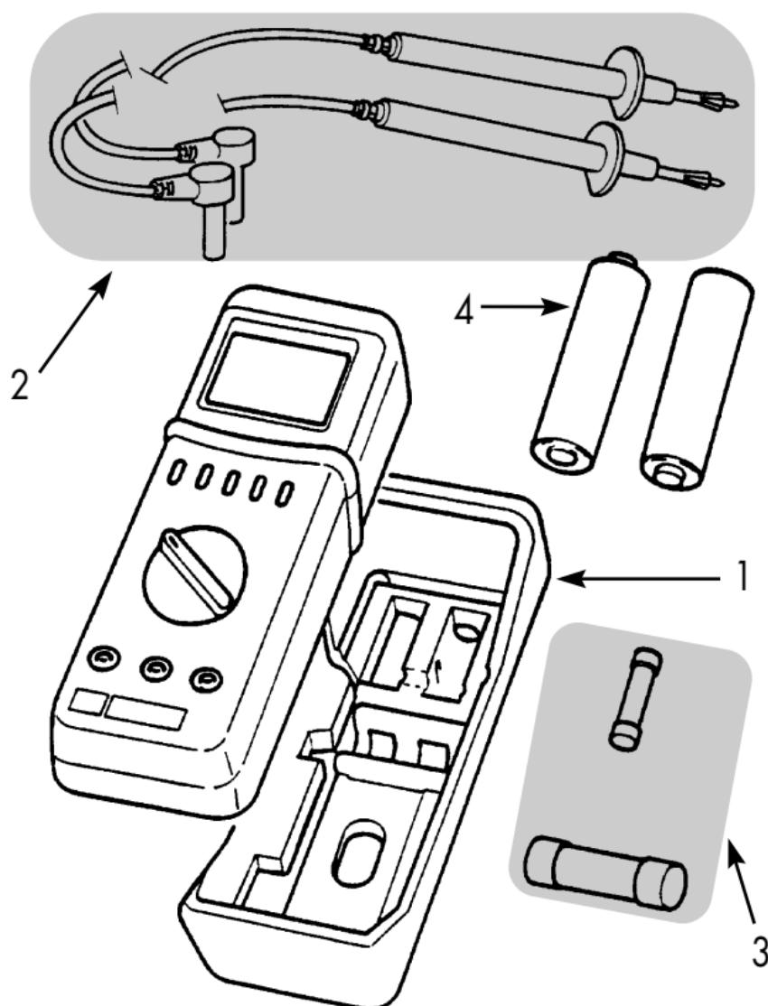
Voor het vervangen van de batterijen en smeltveiligheden dient men de 3 schroeven van de achterwand van het apparaat te verwijderen.
